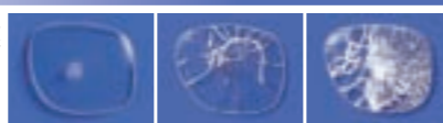
ペトロイドレンズ 一般プラスチック 強化ガラス ※試験条件:250gの鋼球を1.3mの高さから自由落下
